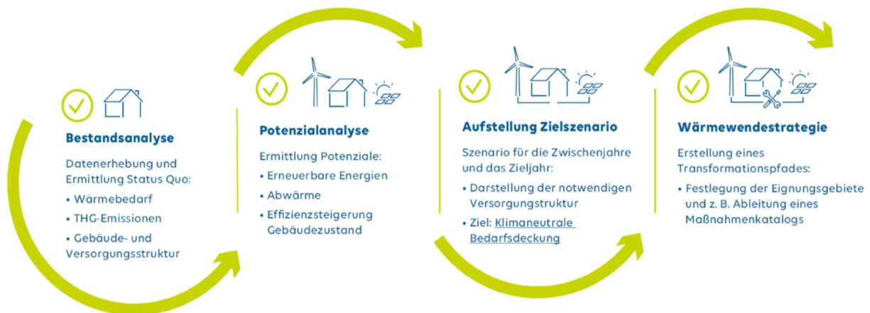
Abbildung 1: Visualisierung der Betrachtungsobjekte im KWP-Prozess
