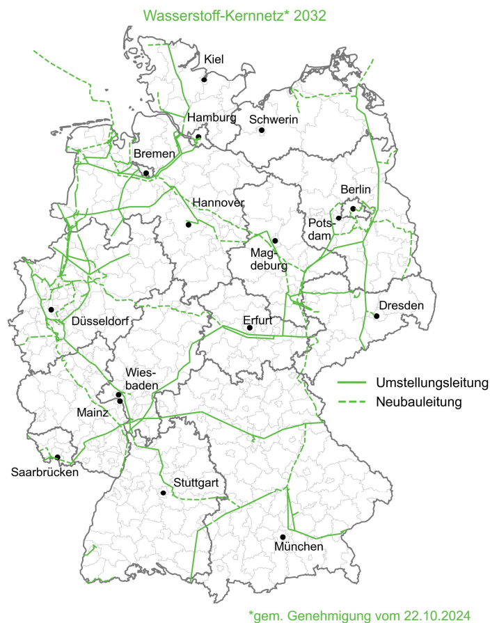
Abbildung 35: Übersicht Wasserstoffkernnetz in Deutschland
